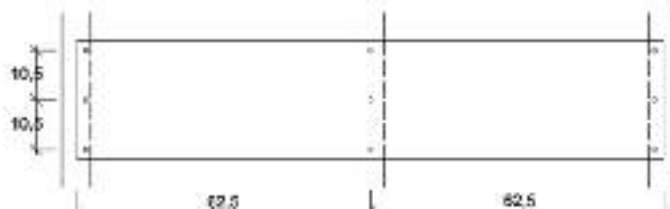
Schraubenbild bei Direktverschraubung in Wandstiele
