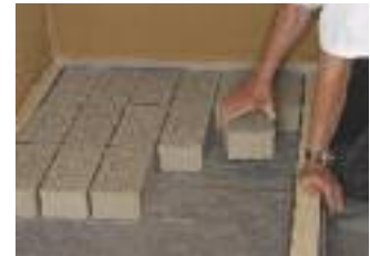
Einlegen der Grünlinge mit 5 mm Fuge
