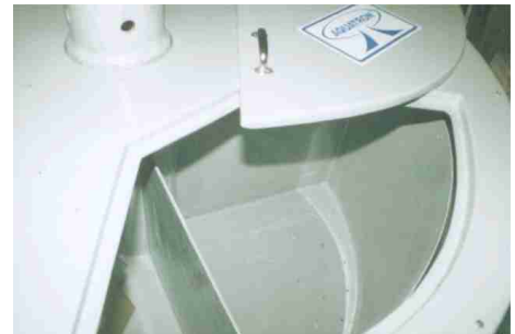
Blick in den drehbaren Innenbehälter vom Aquatron 4x300
