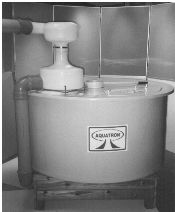
Abbildung 5: Flüssigkeitsablauf des Aquatron 4x300. Die Abbildung zeigt das senkrechte DN 110 Verbindungsrohr.
